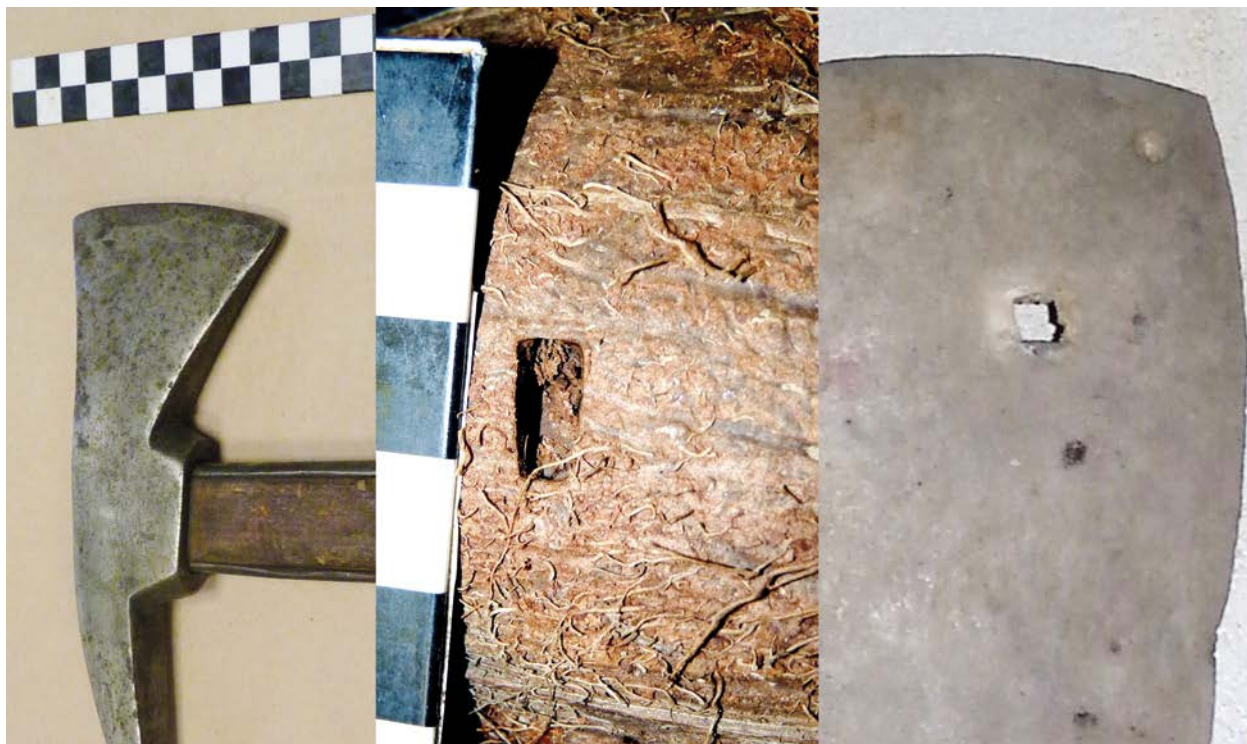
Ryc. 4. Toporek strażacki – efekt uderzenia orzecha kokosowego ostrym końcem i podobne włamanie otrzymane przez Smolagę i wsp.
