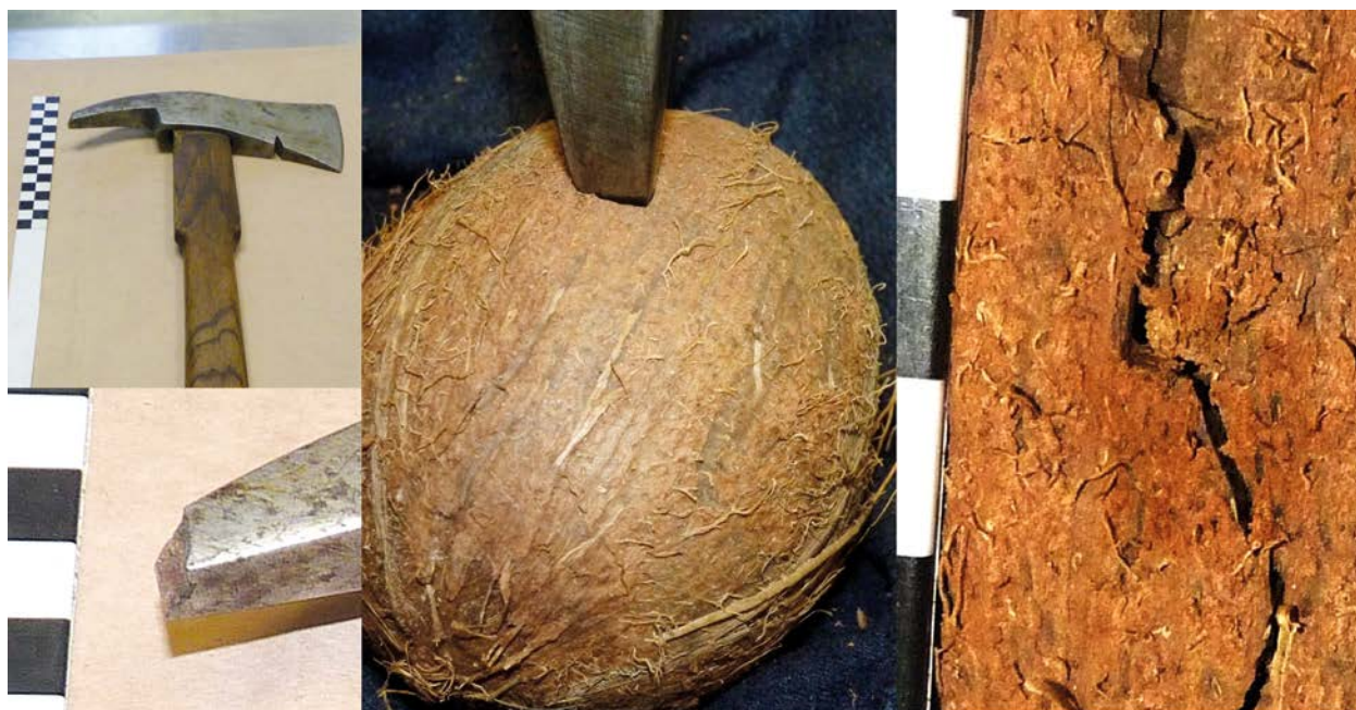
Ryc. 5. Wierne odwzorowanie powierzchni uderzającej toporka strażackiego z ułamanym końcem, z pozostawionym włamaniami o cechach indywidualnych
